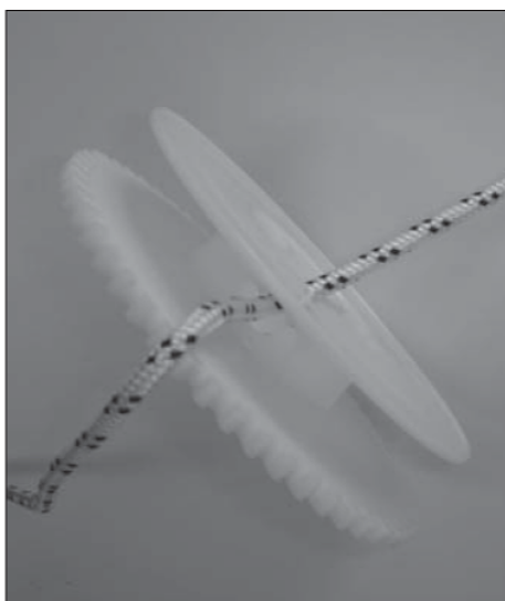
Voer het koord door de spoel en laat deze aan de zijkant eruit komen.
